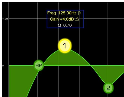
Dans certains cas, il peut s'avérer nécessaire de régler le gain sans changer la fréquence ou d'ajuster la fréquence sans modifier le gain. Dans ce cas, il conviendra d'utiliser les fonctions « Frequency Lock » (Verrouillage de fréquence) ou « Gain Lock » (Verrouillage de gain). Les touches correspondant à ces fonctions sont situées en haut du graphique de l'égaliseur.
