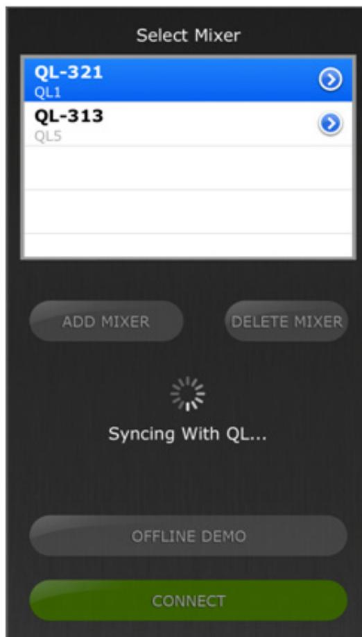
Le message « Syncing With QL... » (Synchronisation avec console QL en cours...) apparaît alors que StageMix tente d'extraire les paramètres de la console. Une fois le processus terminé, la fenêtre de la console de mixage apparaît et l'application StageMix est prête à l'emploi.
