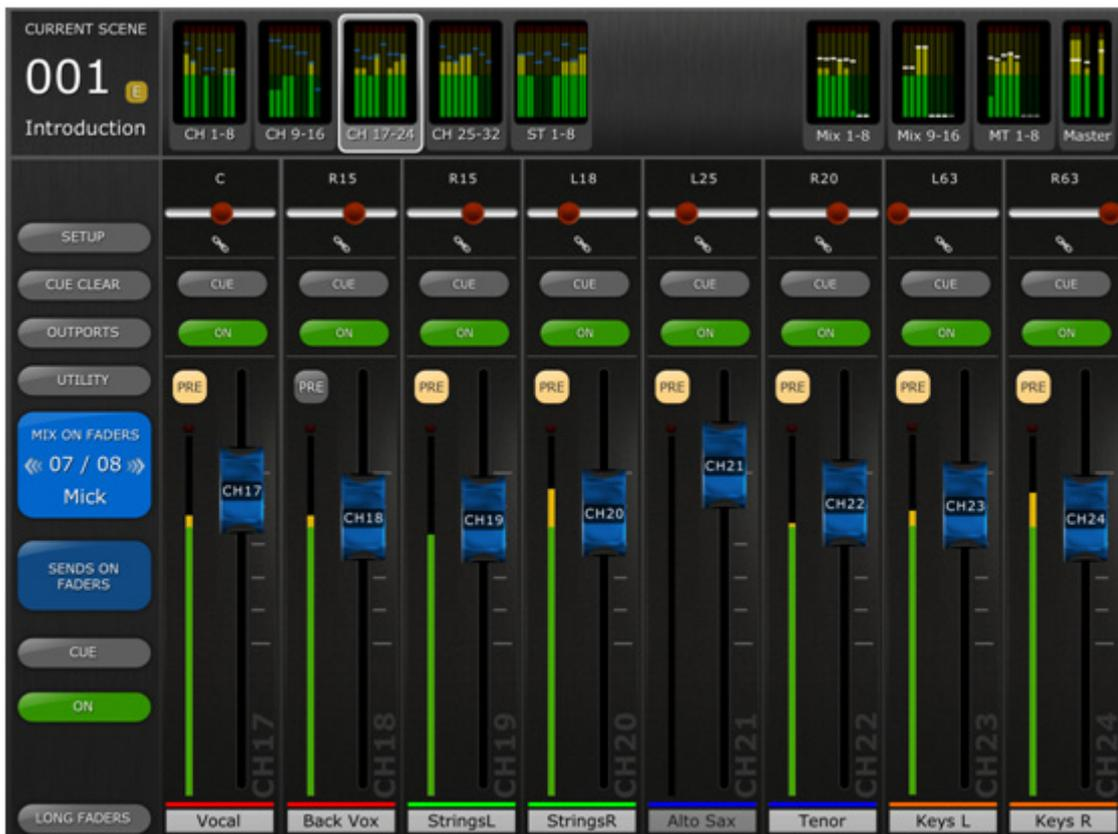
Une large touche [MIX ON FADERS] (Mixage de faders activé) affiche le numéro et le nom du bus Mix actuellement sélectionné. La couleur de cette touche correspond à celle des touches utilisées sur la console de série QL.
