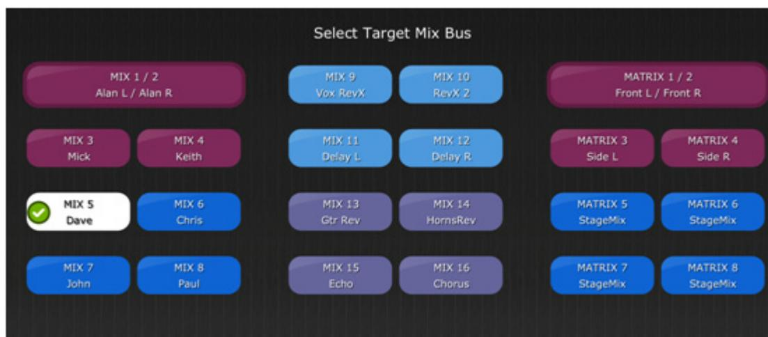
Choisissez le « bus Mix de destination » parmi les bus Mix 1-16 et les bus Matrix 1-8. Le bus Mix actuellement sélectionné s'affiche sous forme d'une touche blanche contenant une coche. Les paires stéréo apparaissent sous forme de grandes touches simples (sans coche).
