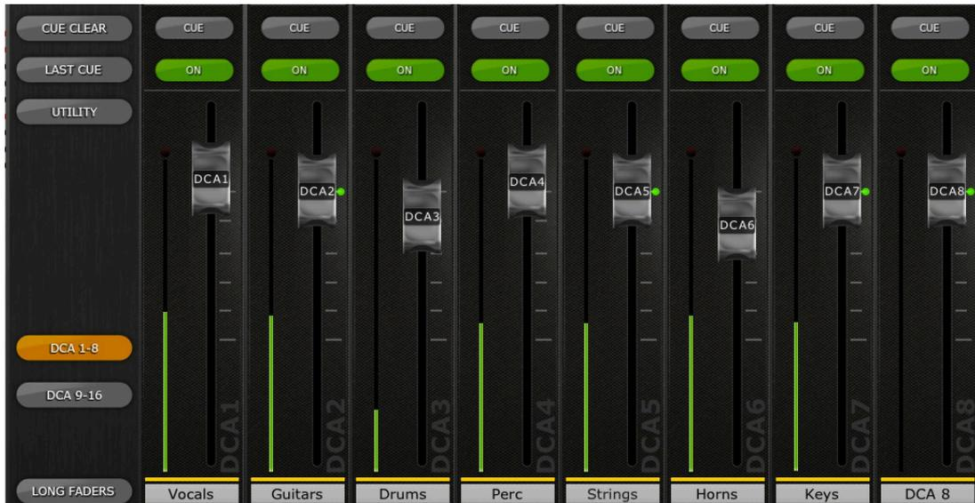
Appuyez à nouveau sur la touche [DCA 1-8] ou [DCA 9-16] pour quitter la banque de faders DCA et retourner sur la banque précédemment sélectionnée. Autrement, appuyez sur n'importe quelle banque dans la section « Navigation/Meter Bridge » afin d'accéder directement à la banque de faders.
