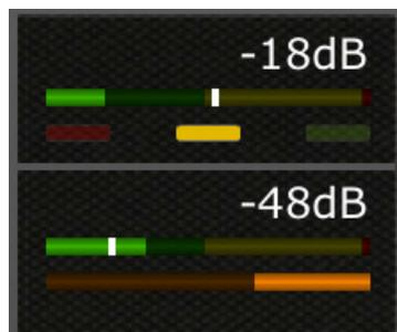
Dynamics 1 s'affiche dans la partie supérieure de la vignette et Dynamics 2 dans la partie inférieure. (Sur les canaux de sortie, seul le paramètre Dynamics 1 est disponible.)
