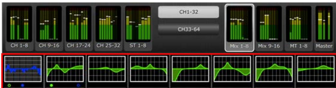
Les points verts et bleus situés sous les différentes courbes d'égaliseur indiquent les types d'égaliseur disponibles sur le canal concerné, ainsi que le type d'égaliseur (PEQ ou GEQ) actuellement affiché pour ce canal. Un point vert signale la présence d'un égaliseur paramétrique et un point bleu celle d'un égaliseur graphique. Lorsque le canal ne dispose que d'un égaliseur paramétrique, aucun point n'apparaîtra sous la courbe.
