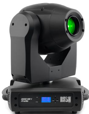
Cette lyre à effets à LEDs super lumineuse, avec optiques à fort rendement, projette une grande variété d'effets et de couleurs de ses deux roues de gobos et de ses deux roues de couleur. Pour plus de souplesse et des effets plus riches, elle dispose d'un gradateur électronique et d'un strobe, d'un iris et d'un prisme à 3 facettes.
