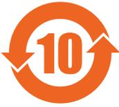
在中国大陆销售的相应电子信息产品(EIP)都必须遵照中国大陆《电子电气产品有害物质限制使用标识要求》标准贴上环保使用期限(EFUP)标签。Barco产品所采用的EFUP标签(请参阅实例,徽标内部的编号用于指定产品)基于中国大陆的《电子信息产品环保使用期限通则》标准。
