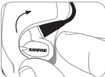
Afferrate il corpo dell'auricolare e ruotatelo delicatamente per rimuoverlo.
